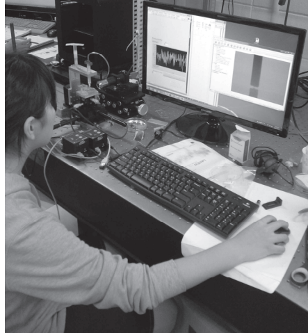
[그림 13] 컴퓨터 프로그램을 이용하여 전동 2축 스테이지를 움직이는 모습. 주사바늘에서 액체금속이 나오고 있는지를 화면으로 볼 수 있다.
