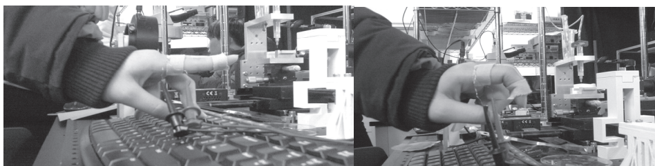
[그림 16] 손가락 관절에 변형률 센서를 붙이고 0^\circ , 70^\circ 굽혔을 때 저항을 측정하는 모습
